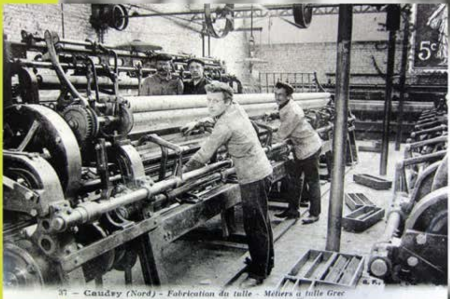
37 - Caudry (Nord) - Fabrication du tulle - Métiers à tulle Grec
